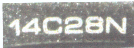
Зображення 5. Збільшений вигляд маркувальних позначень на клинку ножа наданого на дослідження.
